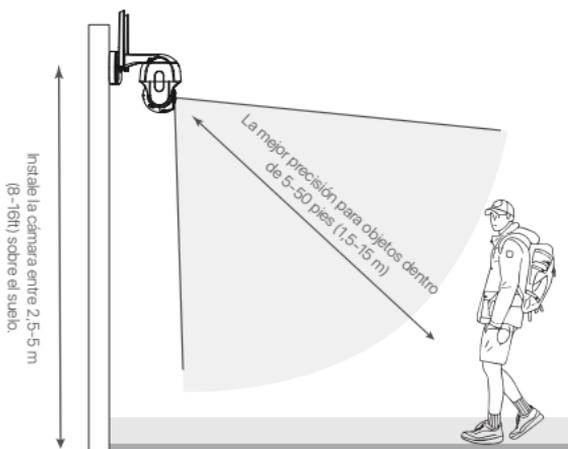
**NOTA:** La precisión de la detección humana se ve afectada por varios factores, como la distancia entre el humano y la cámara, la altura del humano, la altura y el ángulo de la cámara, etc. La tecnología de visión nocturna también afecta la precisión y la distancia de detección.
