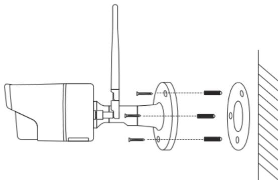
Allineare la base della telecamera alla dima dei fori di montaggio e fissare la base con le viti. (posizionare i cavi della telecamera sulla tacca.)
