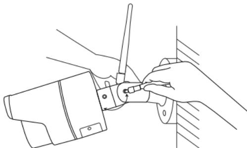
Serrare la manopola di regolazione della staffa per fissare la telecamera.
