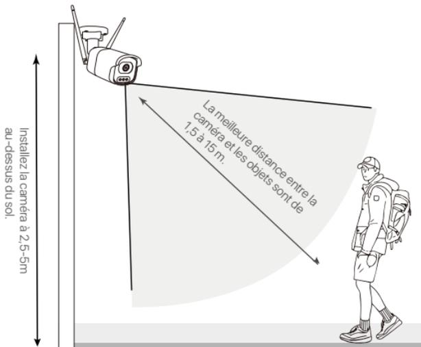
Note : La détection humaine sera affectée par divers facteurs, tels que la distance entre la personne et la caméra, la hauteur du corps humain, et la hauteur et l'angle de la caméra, etc. Dans les environnements de vision nocturne, la précision et la distance de détection peuvent également être affectées.
