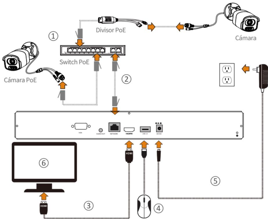
1. Conecte el puerto de red del NVR y el puerto LAN del Switch PoE a través de un cable de red.
