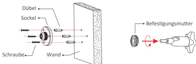
Befestigen Sie die Wandhalterung mit Schrauben an einen geeigneten Standort.
