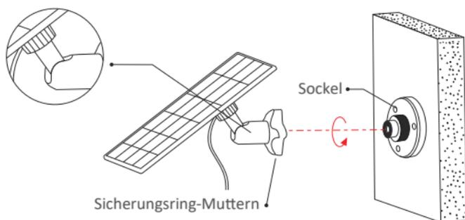
Installieren Sie das Solarpanel an der Halterung und befestigen Sie es mit einer Kontermutter.
