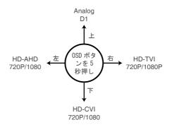
カメラを通電した後、OSDボタンを押してカメラのモードを変更してください。詳細は下記となります:
