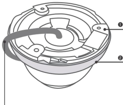
**Remarque:** Le câble doit être fixé sur le trou de la fente.
