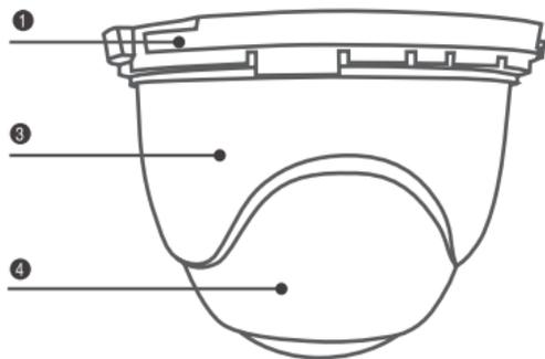
Étape 6: Fixez la **2 Base du dôme** sur **1 Plaque de montage**, puis faites pivoter la Base du dôme dans le sens inverse des aiguilles d'une montre jusqu'à ce que vous entendiez le "clac".
