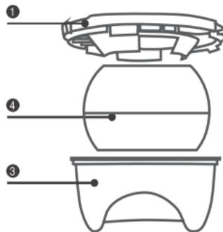
Étape 4: Installez la **1 Plaque de montage** au plafond ou au mur dans la position avec les vis fournies.
