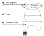
Schritt 4: Installieren Sie die **1 Montageplatte** an der Decke oder der Wand mit den gelieferten Schrauben.
