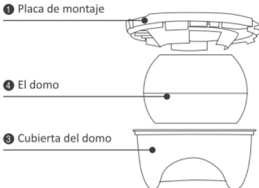
Paso 4. Instale ❶ la placa de montaje en la pared o el techo usando los tornillos en el paquete.
