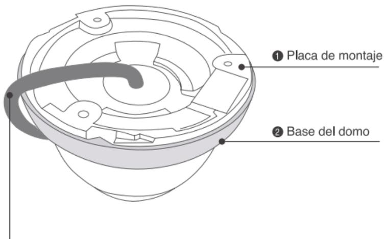
**Nota:** El cable debe fijarse en el orificio de la ranura.
