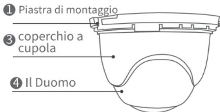
**Nota:** passare il cavo attraverso la piastra di montaggio prima di fissare la piastra di montaggio.
