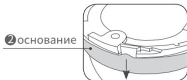
**Г: Просверлите отверстия на стене в соответствии с монтажным шаблоном, вставьте в отверстия настенные заглушки, а затем установите монтажное основание на потолке или стене с помощью винтов, затянутых в настенные заглушки. ПРИМЕЧАНИЕ: Перед тем как закрепить кабель, пропустите его через монтажное основание.**
