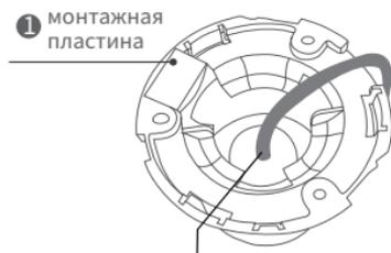
**В: Снимите купольную камеру и ее крышку.**
