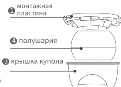
**Д: Установите купольную камеру и крышку на монтажное основание**
