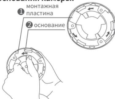
**Б: Снимите основание камеры.**
