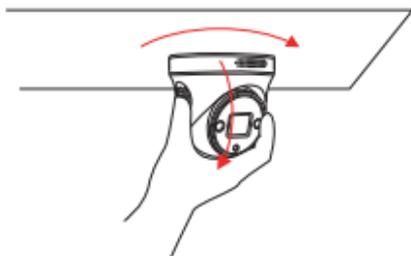
④ Una volta che la telecamera è installata, è possibile ruotare il corpo della telecamera e regolare l'angolo di monitoraggio.
