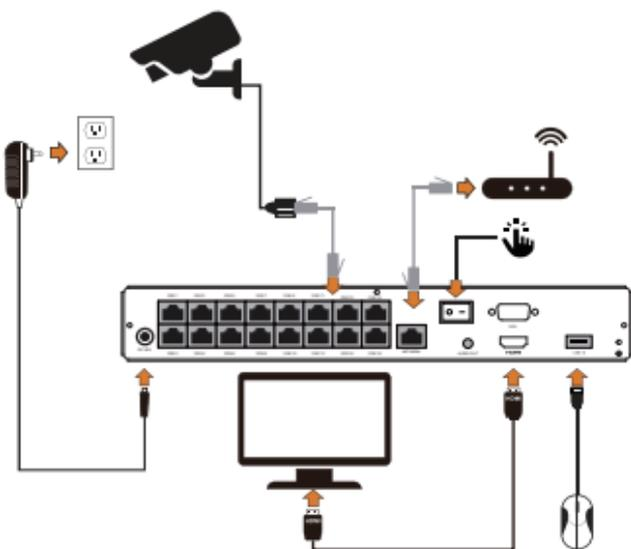
1. Collegare la telecamera alla porta PoE di NVR tramite un cavo Ethernet.
