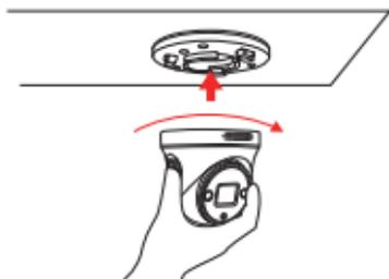
③ Montare la telecamera sulla piastra di montaggio e ruotarla in senso orario per bloccare la telecamera. Assicurarsi che la telecamera sia bloccata in posizione altrimenti potrebbe essere rimossa quando si gira la telecamera in senso antiorario per regolare l'angolo.
