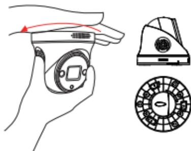
① Tenere premuto sulla parte superiore della telecamera e ruotarla in senso antiorario per ottenere la piastra di montaggio dalla telecamera a cupola.
