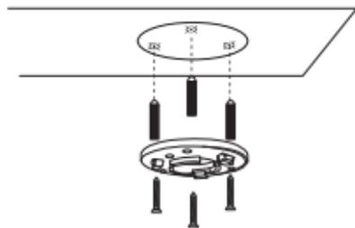
② Praticare fori secondo la dima di montaggio. In seguito, avvitare la piastra di montaggio alla parete nelle posizioni indicate.
