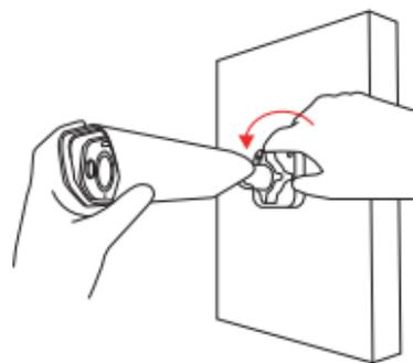
③ Allentare la manopola di regolazione della staffa, ruotare e regolare la telecamera con un angolo corretta.
