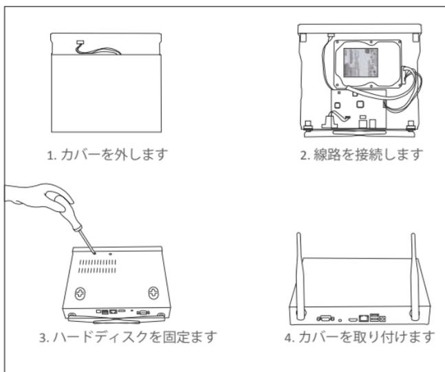
① レコーダーの電源を切ってから取り付けください、ネジを外し、レコーダーのカバーを外してください。
